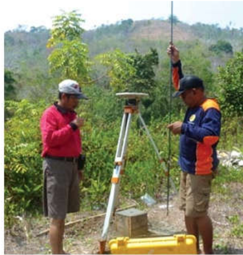
Gambar 6. Contoh Perekaman titik kontrol geodesi turunan yang diikat ke titik kontrol baku melalui satelit GPS.
