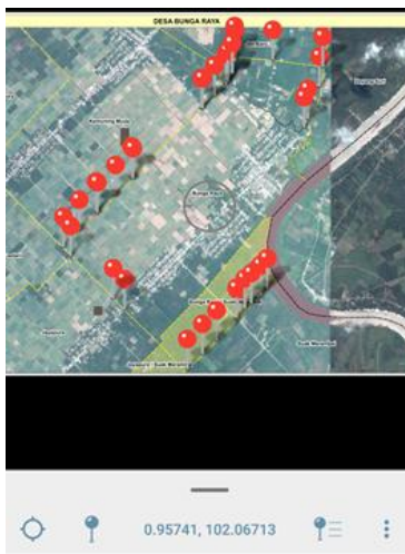
Gambar 43. Contoh pengambilan data batas desa dengan menggunakan aplikasi Avenza Map
