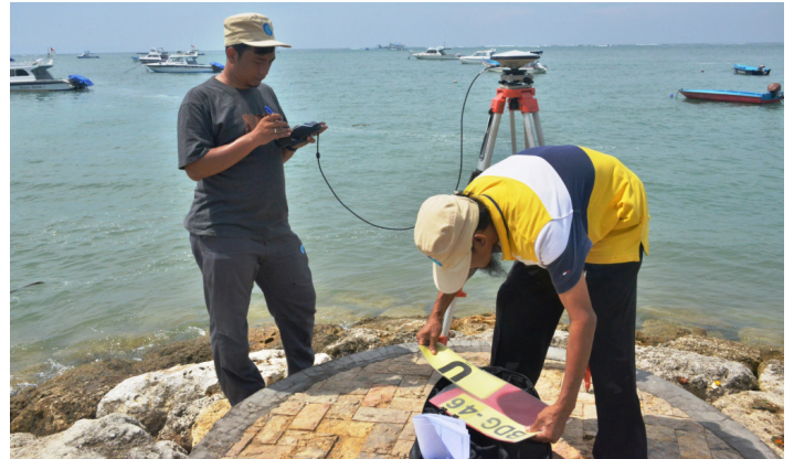
Para pegawai Pusat Pemetaan Tata Ruang dan Atlas BIG sedang melakukan koreksi geometris Ground Control Point (GCP) menggunakan Global Positioning System (GPS) di Kabupaten Badung, Provinsi Bali.
