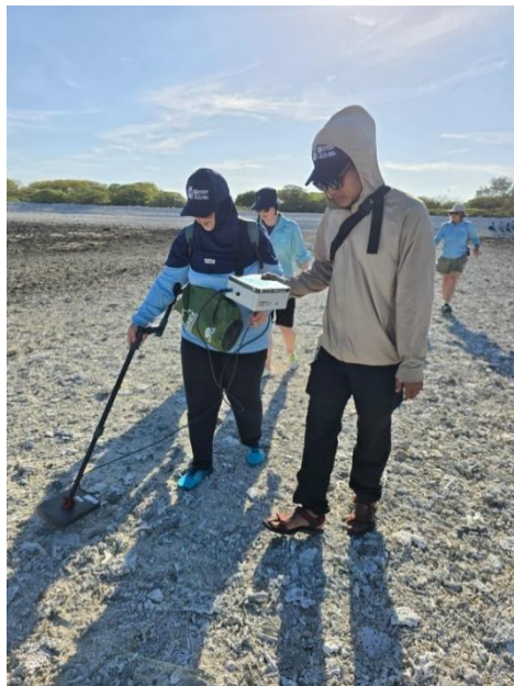
Gambar 41 Pencarian rubber menggunakan GPR
