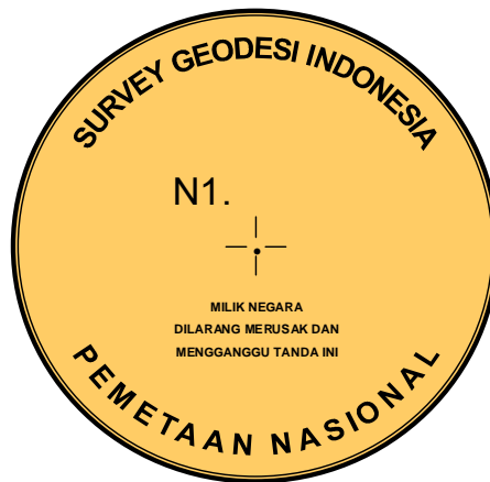
Brass-tablet dan nomor pilar Tampak atas diameter 10 cm
