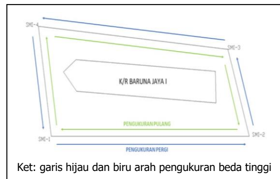
Gambar 3. Ilustrasi poligon dan arah pengukuran kerangka kontrol vertikal.
